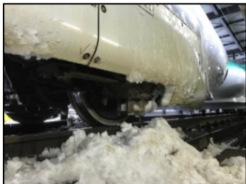
台車周りに雪が付いた状態
